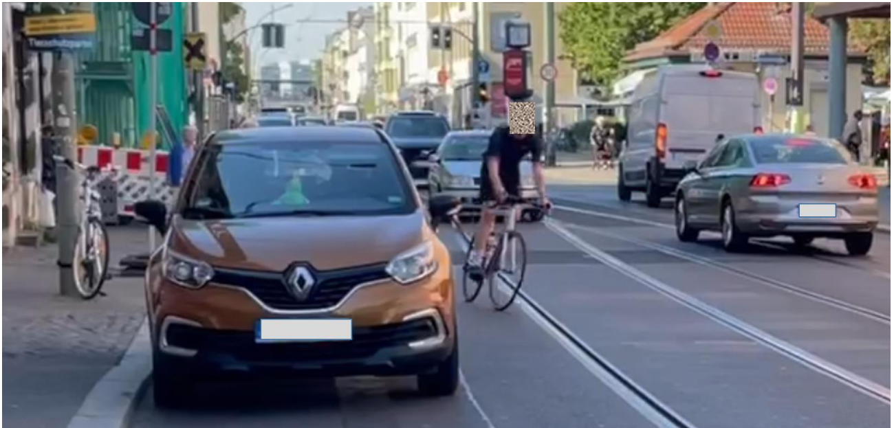
Bild 8: Ausweichmanöver eines Fahrradfahrers zur Gleismitte aufgrund eines haltenden Fahrzeugs
