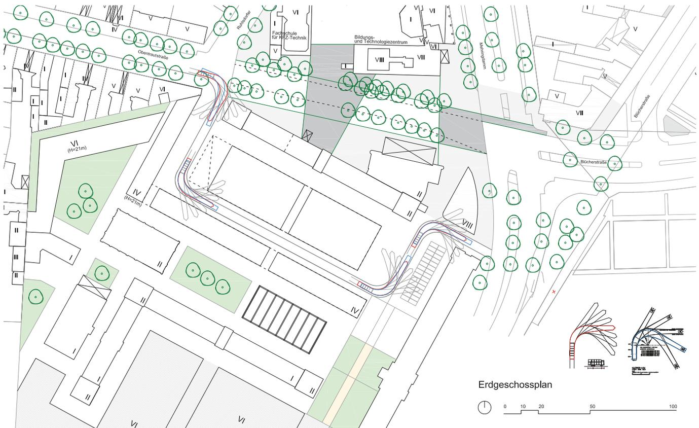
Abb.46 Nachweis der Erschließung durch Schleppkurven eines 3-achsigen Müllfahrzeugs
